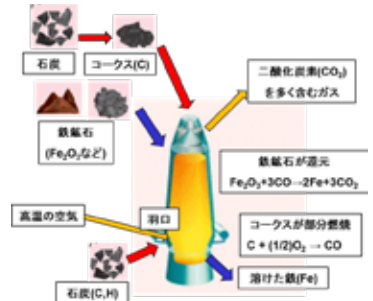
図 高炉による製鉄のしくみ
