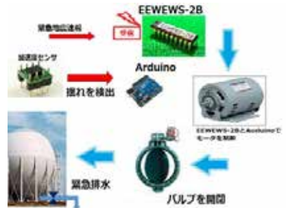
緊急地震速報に連動したLPGタンクのバルブ開閉システム
