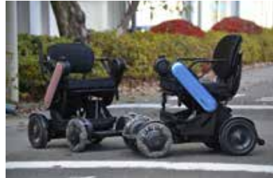
電動車椅子をベースとした自動運転パーソナルモビリティ
